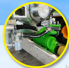
Vacuüm- (11 000 l/min) of wormpomp (3 666 l/min)
